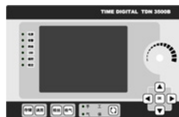
不锈钢材料 脉冲气保焊 电流 140A, 电压 21.5V
