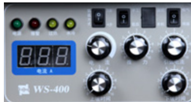
不锈钢材料 氩弧焊 电流 140A ~ 150A
