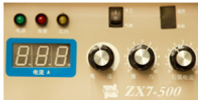
碳钢材料横焊 手工焊 电流 135A
