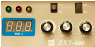
碳钢材料横焊 手工焊 电流 105A
