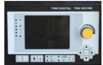
铝镁合金材料 脉冲气保焊 电流 190A ~ 210A，电压 21V ~ 23V
