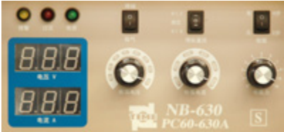
碳钢材料 气保焊横焊 电流 140A ~ 160A, 电压 21.5V ~ 23V
