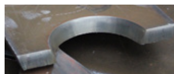
碳钢材料 等离子切割 切割电流 260A
