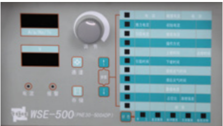
铝镁合金材料 交直流方波焊 电流 160A
