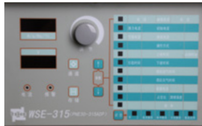
铝镁合金材料 交直流方波焊 电流 155A
