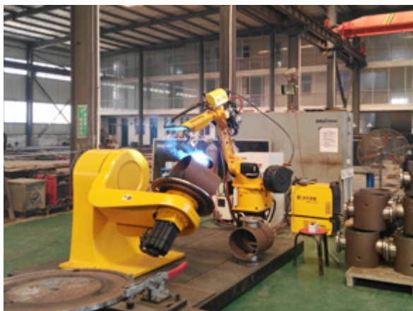
河南高压电气件焊接
